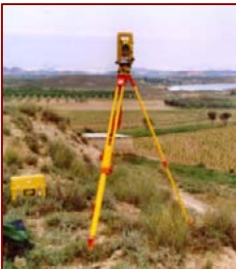
Fig. 6.20 - Estación Total Electrónica.
