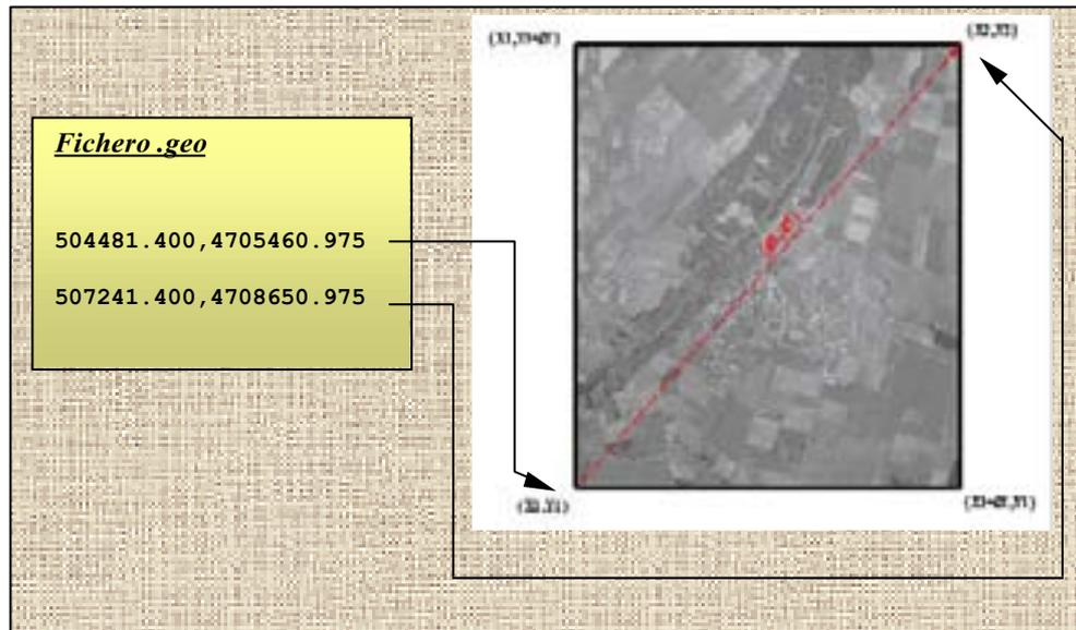
Fig. 4.7 - Esquema de georreferenciación con ficheros (.geo).
