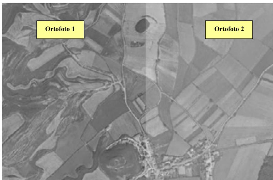
*Fig. 4.1 - Diferente contraste radiométrico entre ortofotografías contiguas.*
