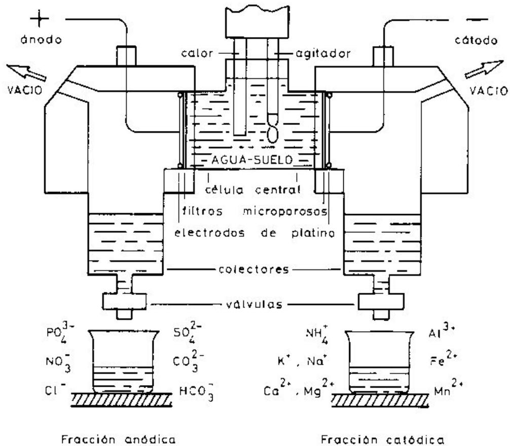
**Figura 9:** Esquema del sistema de electroultrafiltración.
